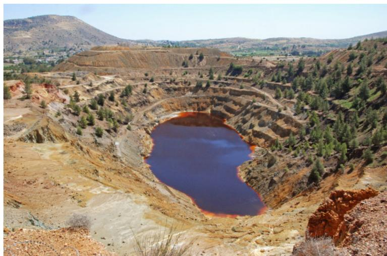
Abb. 44: Die Mitsero-Mine mit dem Eisensulfatsee im Abbaukrater, rundum Reste des „Eisernen Huts“ in allen Farben von weiß, ocker über rot bis lila.
