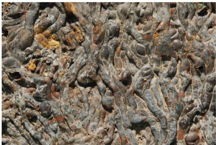
Abb. 37: Detail der Fließstrukturen in den Eisensilikat-Schlacken ( $Fe_2SiO_4$ ), Abfallprodukt antiker Kupferverhüttung, die sich hier in gut 10 m hohen und ca. 200 m langen Halden türmen (Resthalden nach Abtrag u.a. wegen Schotterverarbeitung und Expansion der modernen Mine). Die Stränge sind etwa fingerdick.
