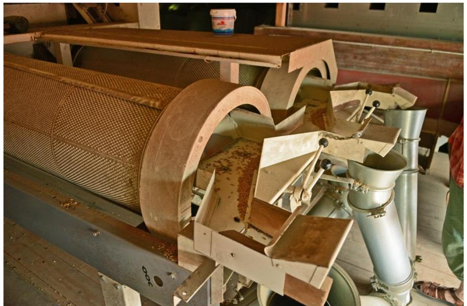
**Abb. 3:** *Trieur-Stufe der Gersten-Linsen-Sortierung auf dem Bio-Hofgut: Die Linsen passen genau in die Näpfchen der Trommelwand und werden mit deren Drehung nach oben befördert, von wo sie in eine mittig angeordnete Schütte fallen. Die Gerstenkörner rollen hingegen am Boden der Trommel zu einem anderen Auslauf.*
