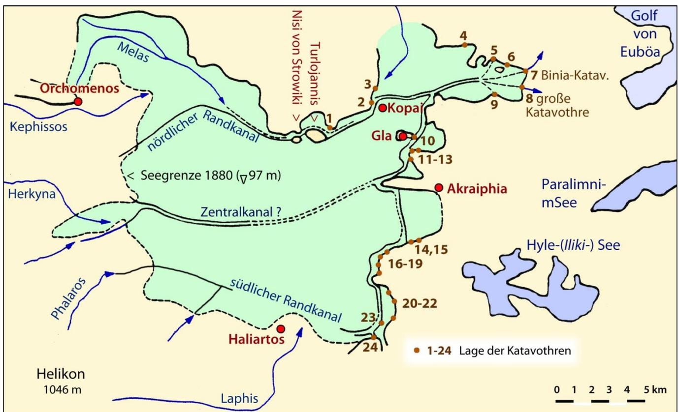
**Abb. 18:** Aufarbeitung einer Kartierung minyischer Kanäle von 1892/93. Der nördliche Randkanal kann als gesichert gelten, vom südlichen Randkanal fanden sich schon damals nur Fragmente, die insbesondere die Flüsse aus dem Helikon-Gebirge abzuleiten hatten. Der hypothetische Zentralkanal stammt – je-
