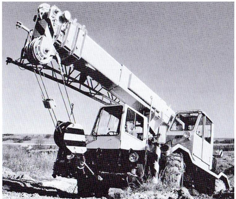
**Abb. 3:** der erste Liebherr All-Terrain-Mobilkran (LTM 1025) mit 25 t Tragleistung im Einsatz (aus einer Liebherr-Image-Broschüre).
