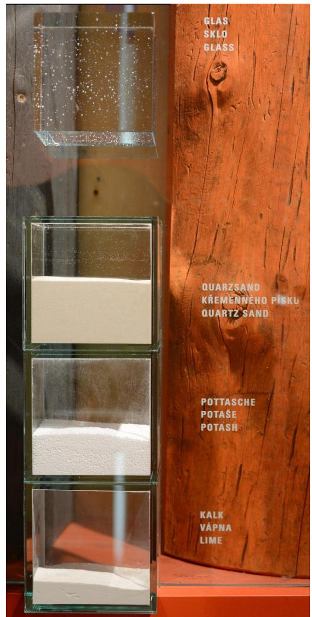
verringert den Schmelzpunkt des Quarzes von 1790 °C auf etwa 1350 °C. Diese Temperatur konnte man in den mit Holz befeuerten Glasöfen gerade noch erreichen. Um 1,5 kg Glas herstellen zu können, benötigt man die Energie aus dem Holz der beiden roten und die Asche der vier grauen Stämme.
