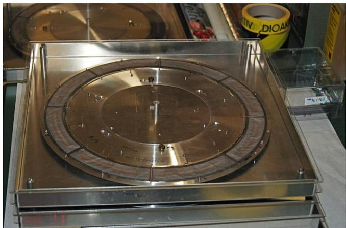
**Abb. 3:** scheinbar so einfach wie ein Plattenspieler: Targetrad in seinem Schutzbehälter
